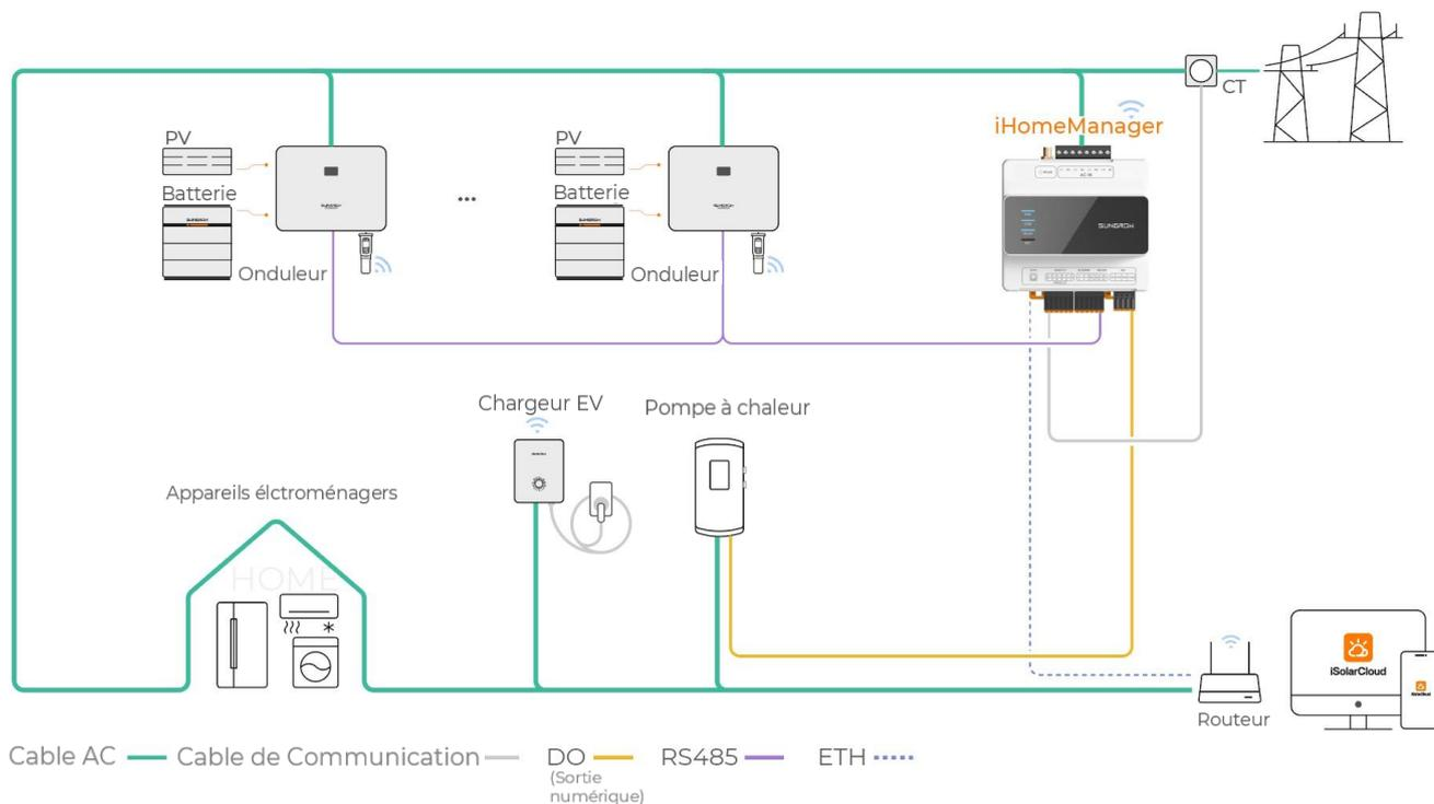
\* Le iHomeManager est compatible à la fois avec un mode de communication câblé et sans fil avec l'onduleur. Le schéma ci-dessus illustre la solution câblée.
